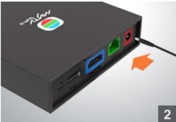
如選擇以有線(LAN)連接上網，請連接隨解碼器提供的網絡線至主機的綠色接口，另一端則接駁至網路裝置，如路由器。
